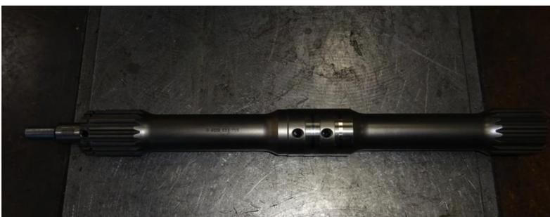
Рис.9 Турбинный вал.
